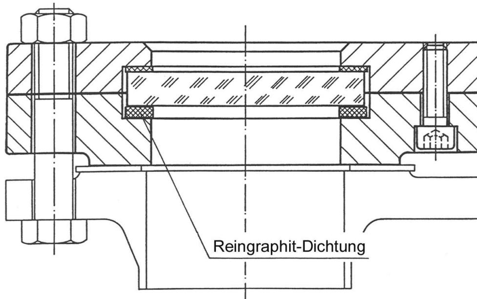
Die bestens bewährte Ausführung nach DIN 28121 ist auf Grund des Dichtungswerkstoffes PTFE auf eine Betriebstemperatur von max. 200°C beschränkt. Um alle bekannten Vorteile der Ausführung nach DIN 28121 auch bei höheren Temperaturen zu gewährleisten, wurden diese Versionen entwickelt.
